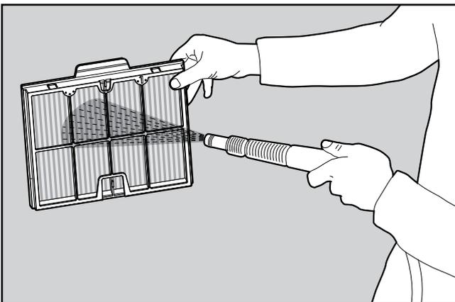
**6.2.4** Den Filter mit einem Schlauch reinigen.
