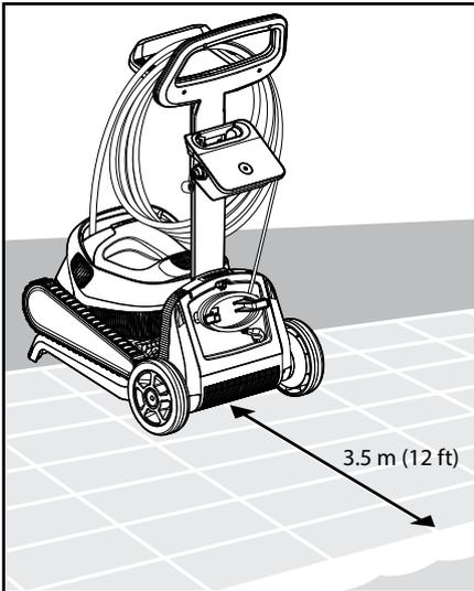
**5.1.1** Das Netzteil so positionieren, dass es sich etwa in der Mitte der Längsseite des Pools 3,5 m (12 Fuß) von ihm weg befindet.
