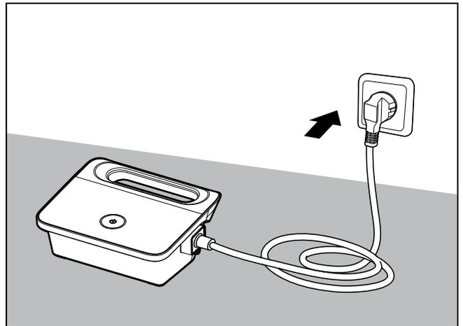
**5.1.4** Das Stromversorgungsgerät ans Netz anschließen und auf AUS lassen.
