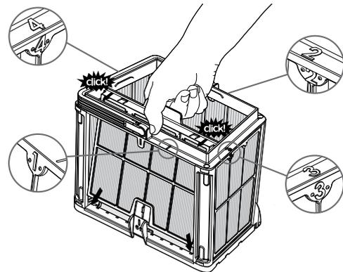
**6.2.5** Die Filterplatten in der folgenden Reihenfolge montieren: Platte 4 → 3 → 2 → 1.
