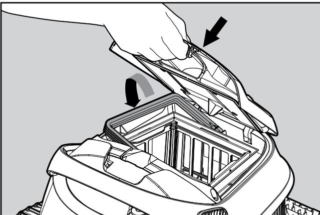
**6.2.6** Den sauberen Filterkorb einsetzen und den Filterdeckel schließen.
