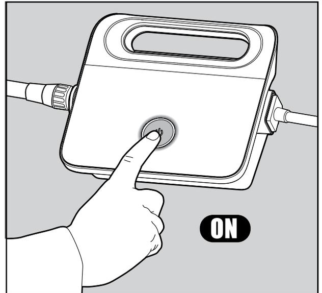
**5.2.2** Schalten Sie den Strom EIN. Der Poolreiniger ist nun in Betrieb, bis er das Ende des Reinigungszyklus erreicht hat.
